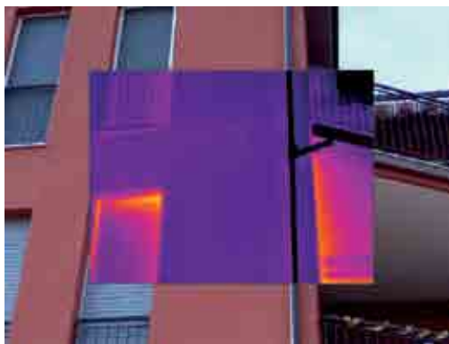
PERUGIA - ATER CASTEL RITALDI, ANNO 2006 IN EVIDENZA L'IMPORTANZA DELLA POSA IN OPERA DEL CAPPOTTO TERMICO. L'IMMAGINE DI SINISTRA MOSTRA UNA TEMPERATURA OMO- GENEA RISPETTO ALLE DISCONTI- NUITÀ MISURATE NELLA FOTO DI DESTRA >>
