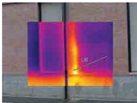
Ponti termici in corrispondenza dei caloriferi e dell'impianto termico con gradienti di temperatura di circa 6°C
