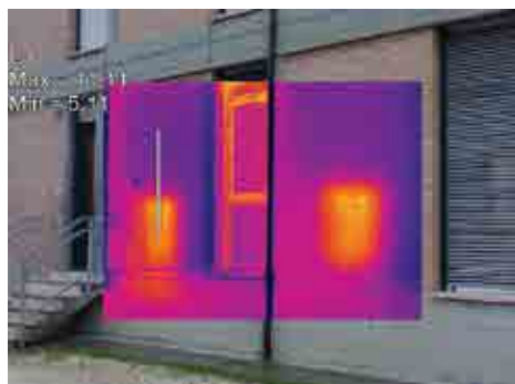
Ponti termici in corrispondenza dei caloriferi e dell'impianto termico con gradienti di temperatura di circa 6°C
