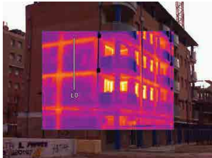
BOLOGNA - VIA ZANOLINI, ANNO 2010 TEMPERATURE DISOMOGENEE SULLE FACCIAE E PONTI TERMICI IN CORRISPONDENZA DELLE STRUTTURE PORTANTI >>
