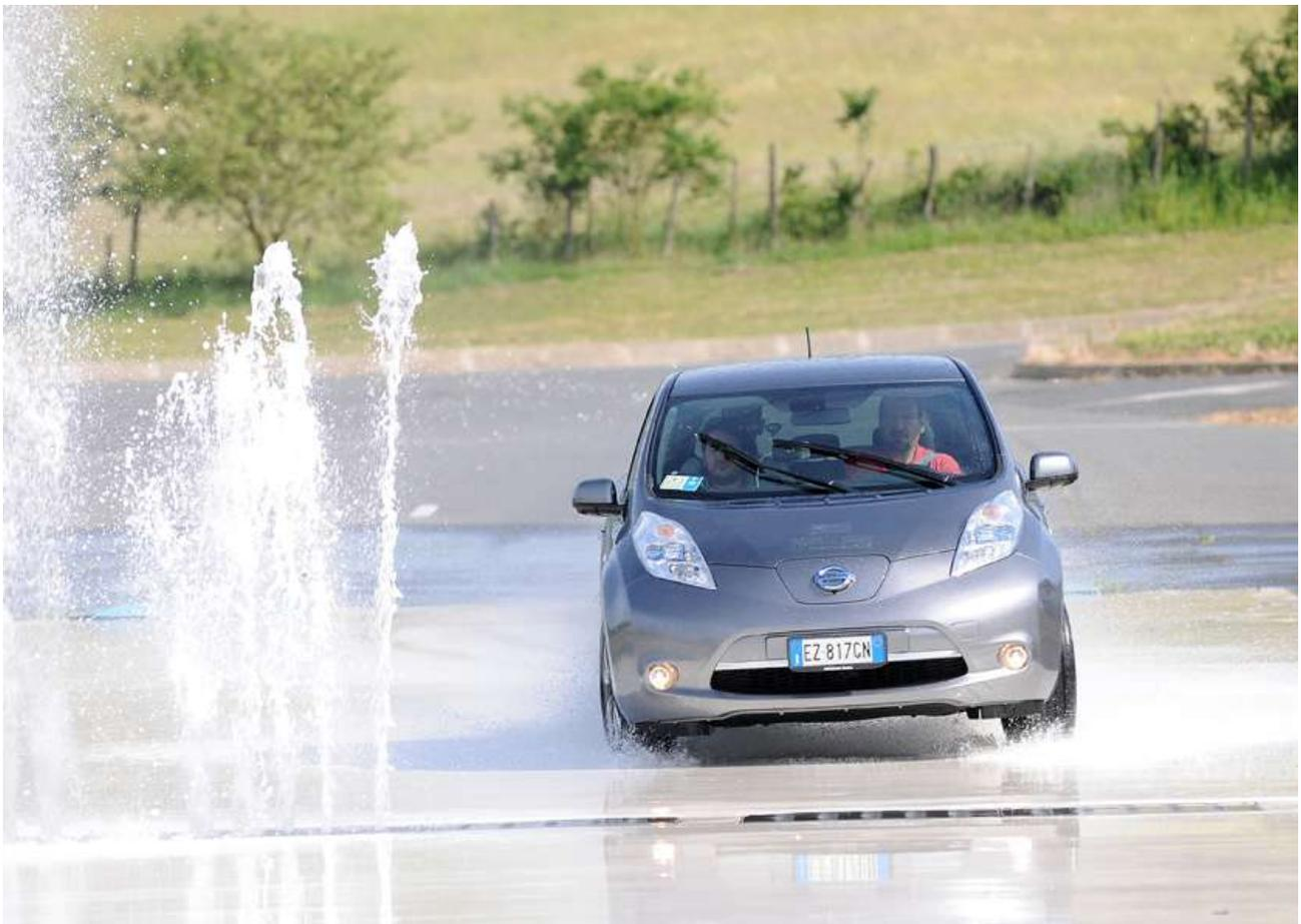
Le prime quattro prove sono state effettuate sull'autodromo di Vallelunga con l'ausilio delle strumentazioni installate a bordo ed hanno consistito: per la prima prova al raggiungimento della velocità massima, la seconda prova è servita alla valutazione dell'accelerazione dell'auto quindi alla misurazione del tempo impiegato dall'auto per raggiungere i 100 km/h con partenza da fermo, la terza e la quarta prova sono servite a
